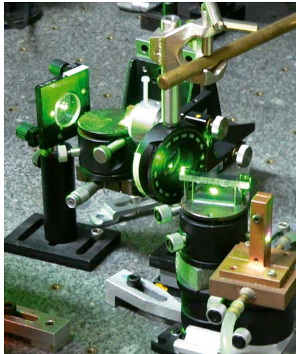
Die neue Laserquelle (hier ein Teil des optischen Aufbaus) kombiniert erstmals zwei Methoden zur passiven Modenkopplung.
