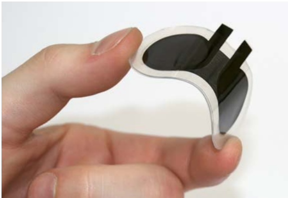
Die gedruckte Batterie mit zwei in Reihe geschalteten Zellen ist recht flexibel.
