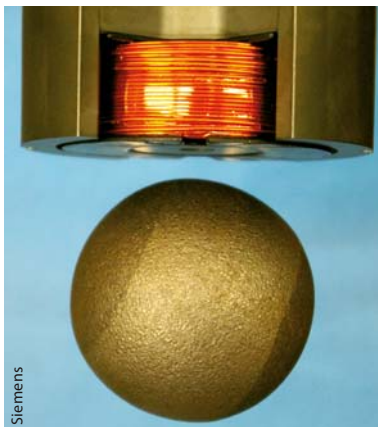
Beim Siemens-Demonstrator hält ein Elektromagnet eine Metallkugel in der Schwebe.
