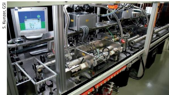
Abb. 5 Damit die Luft nicht ionisiert wird, verläuft im Vorverstärker ein großer Teil des Lichtwegs in Vakuumrohren. In der Bildmitte befindet sich der Verstärker mit 45 mm Durchmesser.
