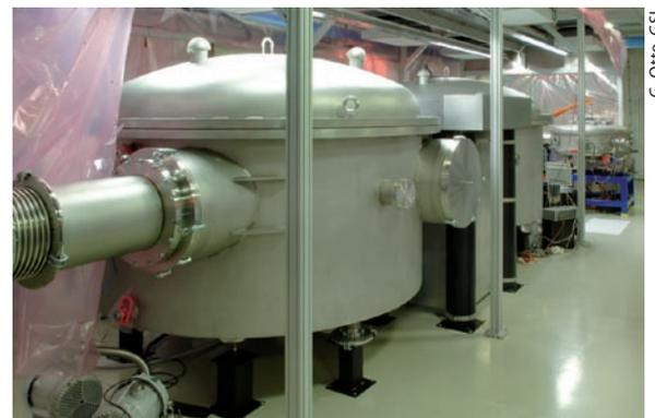
Abb. 6 Im Vordergrund steht die aus zwei zylindrischen Rezipienten bestehende Kompressorkammer. Im Hintergrund ist die Experimentierkammer zu erkennen.
