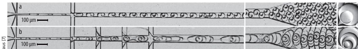
Abb. 4 Für doppelte Emulsionen (a) wird zunächst eine Wasser-in-Öl-Emulsion hergestellt (links, mit langgezogenen Tröpfchen), die in einer kontinuierlichen
