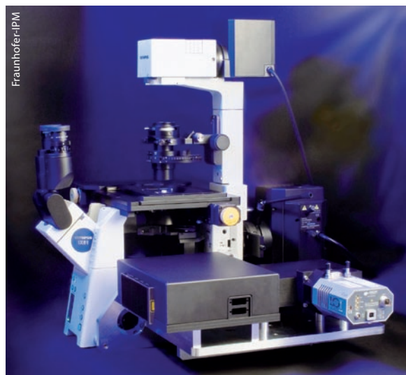
Mit einem Raman-Spektrometer lassen sich Keime aufspüren.
