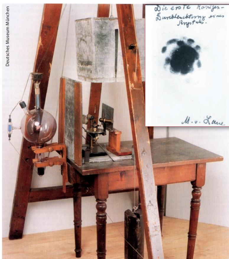
Versuchsordnung zum Nachweis der Beugung von Röntgenstrahlen und eine der ersten Interferenzaufnahmen.
