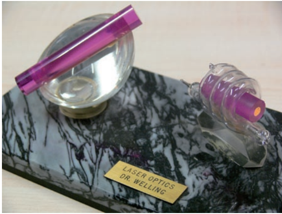
Abb. 1 Diese Rubinstäbe und die Entladungslampe sind Originale, die Theodore Maiman dem Autor schenkte.
