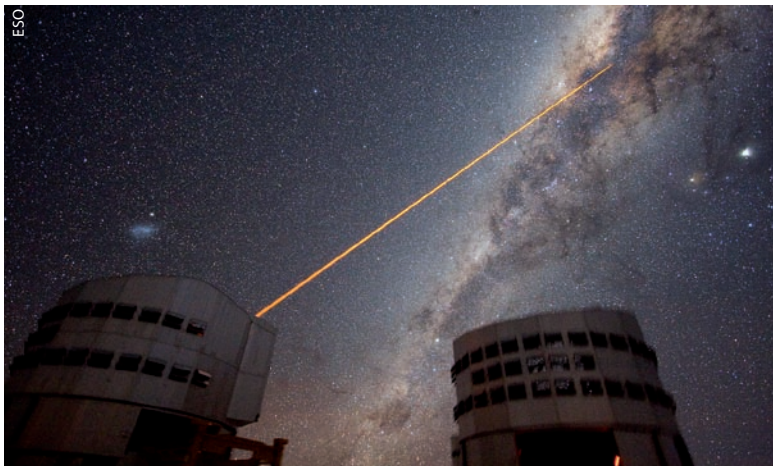
Abb. 4 Mithilfe eines Lasers lassen sich Natriumatome in der oberen Atmosphäre anregen, deren Licht einen hellen Stern
