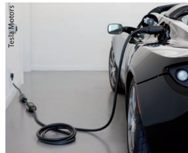
Abb. 4 Der Tesla Roadster hat als erstes serienmäßiges Elektrofahrzeug auf Lithion-Basis mehr als 6000 industrieübliche Akkus an Bord. Das Laden dauert laut Hersteller 3,5 Stunden und verschafft dem Stromer eine Reichweite von 100 bis 500 Kilometern.
