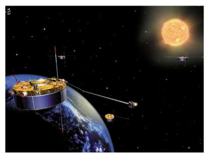
Die rotierenden zylindrischen Satelliten von 2,90 Metern Durchmesser und 1,30 Metern Höhe absolvieren ihre 57 Stun-
