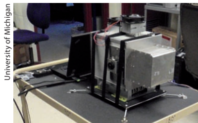
Der Detektor der University of Michigan kann Gammastrahler genau lokalisieren.
