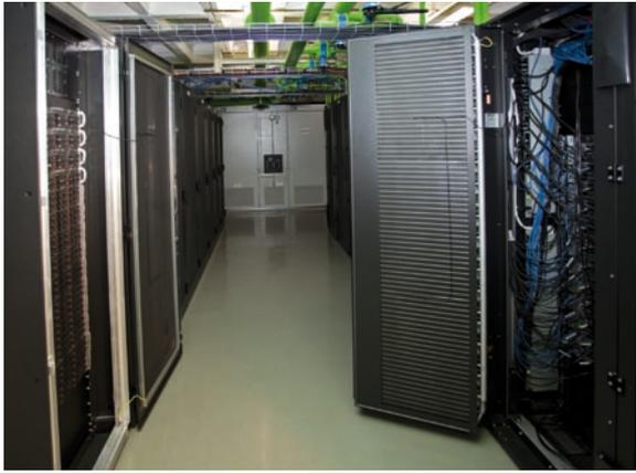
**Abb. 7** Der neue Hochleistungsrechner „LOEWE-CSC“ der Universität Frankfurt enthält insgesamt 772 GPUs und 20 928 Prozessorkerne. Auf der Liste der weltweit schnellsten Großrechner belegt er Platz 22 und Platz 8 auf der Liste der energieeffizientesten Rechner.
