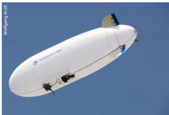
Ein Zeppelin ermöglicht besonders energieeffiziente Überwachungsflüge mit einem Radiometer an seiner Unterseite.
