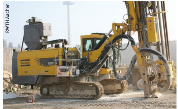
Ein Laseranalysator (Kasten über der Raupenkette) bestimmt die Zusammensetzung des Gesteins in Echtzeit.
