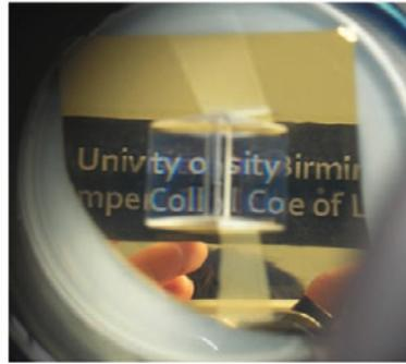
**Abb. 2** Eine kleine Bodenwelle in einem Schriftband lässt sich mit zwei doppelbrechenden Kristallen unsichtbar machen, allerdings nur für geeignet polari-
