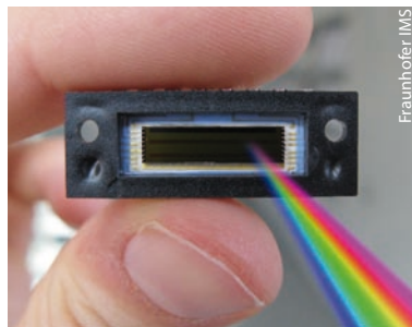
Eine modifizierte Passivierungsschicht erweitert die spektrale Empfindlichkeit von CMOS-Bildsensoren.
