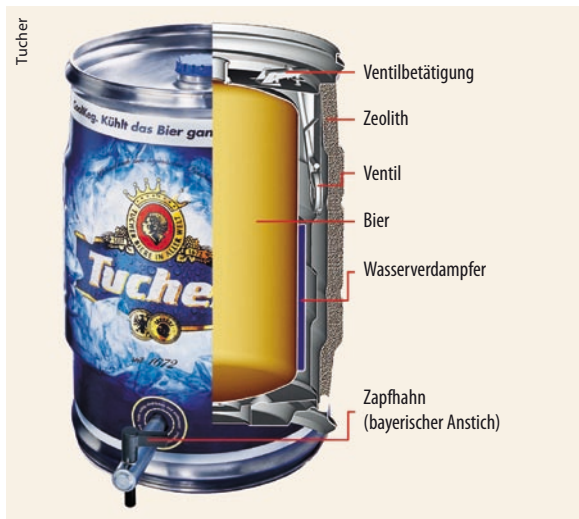
Abb. 1 Ein selbstkühlendes Bierfass im Querschnitt: Öffnet der Kunde das Ventil zwischen Zeolithschicht und Wasserverdampfer, sinkt der Druck über der wassertragenden Schicht schlagartig und unterschreitet den Dampfdruck des Wassers. Die Wassermoleküle strömen in die Zeolithschicht und werden dort adsorbiert. Die erforderliche Verdampfungsenergie entzieht das Wasser dem Bier in der Fassblase.
