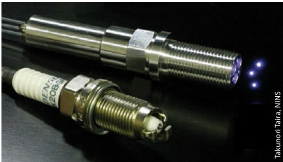
Gleiche Bauform, unterschiedliche Energieerzeugung: „Laserkerze“ und Zündkerze.
