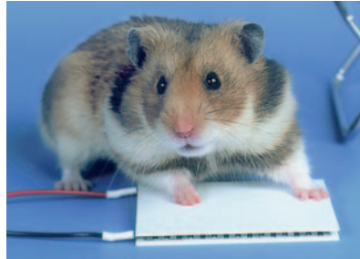
Abb. 4: Peltier-Elemente sind, wie man sieht, kleine und kompakte Kühlelemente. (Foto: K. Sengebusch/EURECA GmbH)
