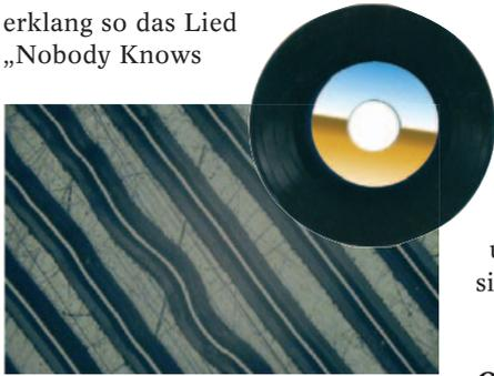
Ausgehend von hochaufgelösten lichtmikroskopischen Bildern der feinen Plattenrillen lassen sich alte und empfindliche Tonaufnahmen berührungsfrei rekonstruieren und abspielen. (Foto: LBNL)
