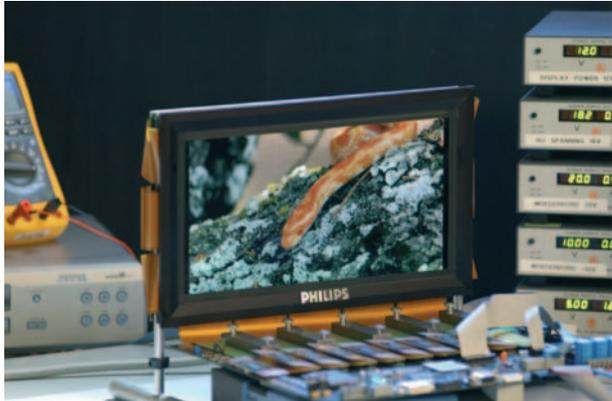
Der Prototyp eines Flachbildschirms aus organischen Leuchtdioden. (Foto: Philips)
