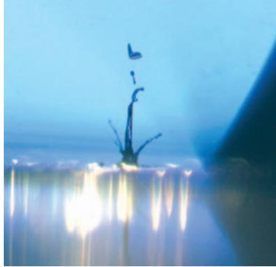
**Abb. 4:** Beim „Laser Pressure Catapulting“ lässt sich etwa aus einer Zellmembran eine Probe herauschneiden und mit einem Laserpuls in einen Auffangbehälter katapultieren (Foto: P.A.L.M.).
