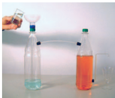
Abb. 1: Plastikflaschen eignen sich hervorragend für Experimente aus der ganzen Physik. Der Weinautomat des Heron von Alexandria ermöglichte es, Wasser in Wein umzuwandeln.
