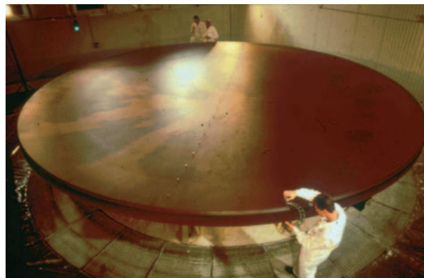
Abb. 3: Einer der vier 8,2-m-Spiegelträger für das Very Large Telescope der Europäischen Südsternwarte, gefertigt aus einer Glaskeramik.
