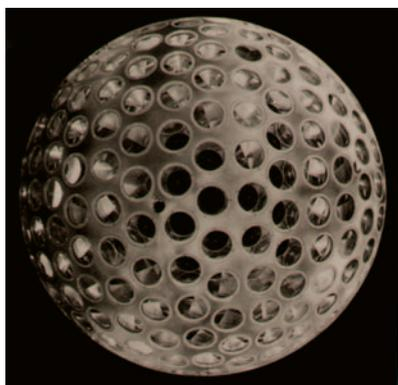
**Abb. 2:** Der LAGEOS-Satellit ist eine 410 kg schwere Kugel von 60 cm Durchmesser mit 426 Retroreflektoren (Katzenaugen) rundum (Quelle: NASA).
