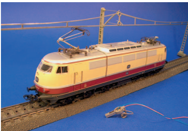
Bei dieser Modelllok hebt und senkt der nur 1,5 Gramm schwere Piezo-Motor den Stromabnehmer naturgetreu. (Foto: Elliptec Resonant Actuator GmbH)
