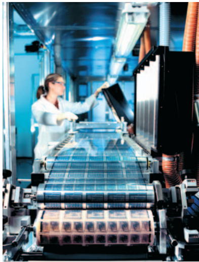
Chips von der Rolle: Die RFID-Chips von PolyIC sind mit 600 kHz die weltweit schnellsten organischen integrierten Schaltungen. (Foto: Siemens)
