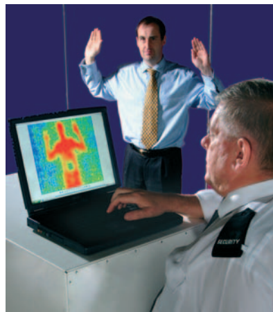
Die vom menschlichen Körper ausgehende Terahertz-Strahlung durchdringt die Kleidung und lässt sich für Sicherheitschecks detektieren. (Quelle: ThruVision)
