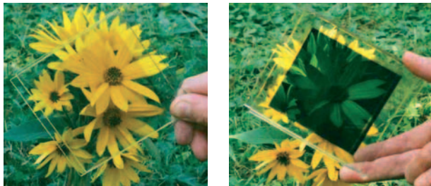
Photochromes Glas färbt sich stark ein, wenn es intensivem Sonnenlicht ausgesetzt wird. (Quelle: ISE)
