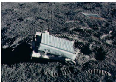
Reflektoren auf dem Mond ermöglichen es, die Entfernung zwischen Erde und Mond mit Laserhilfe auf wenige Zentimeter genau zu bestimmen (Foto: NASA).
