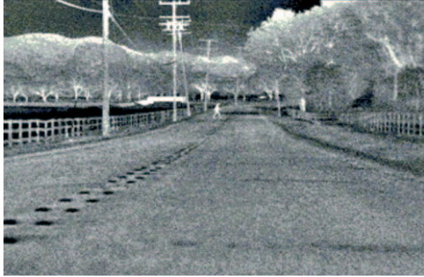
Abb. 6: Diese nächtliche Infrarotaufnahme wurde mit einem ungekühlten Detektor aufgenommen. Seine aktiven Elemente sind Pixel aus einer ferroelektrischen (\text{Pb},\text{La})(\text{Zr},\text{Ti})\text{O}_3 -Schicht, die im pyroelektrischen Modus ausgelesen werden (Quelle: L-3 Communications Infrared Products).
