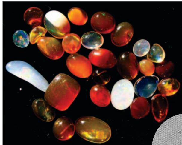
**Abb. 1:** Für die schillernden Farben von Opal sind etwa 250 nm große und regelmäßig angeordnete Kügelchen aus Siliziumdioxid verantwortlich, die auf dem vergrößerten Ausschnitt unten (Durchmesser ca. 10  $\mu\text{m}$ ) zu erkennen sind.
