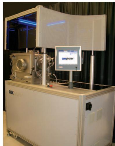
Abb. 3: Das kompakte vollautomatisierte PLD-System AXPLORER. Der COMPexPro Laser inklusive Optik sowie das Vakuumsystem plus Steuerung sind im unteren Teil des Gehäuses integriert. Die Beschichtungskammer ist über eine große Beladungstür zugänglich. Die Parameter des Beschichtungsprozesses können über das Touch-Panel eingegeben und überwacht werden.
