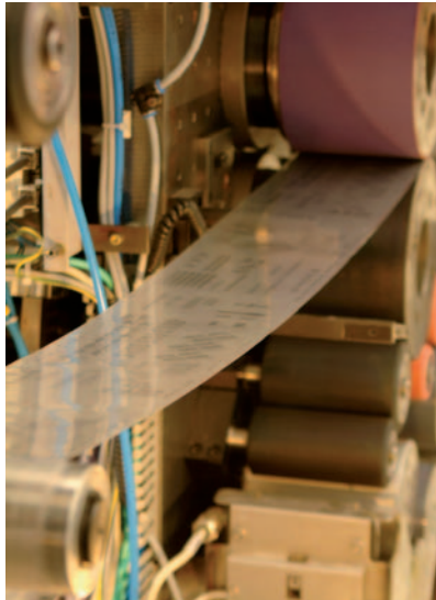
Die geschickte Kombination gängiger Druckverfahren ermöglicht eine günstige Massenfertigung einfacher elektronischer Schaltungen. (Foto: pmTUC, TU Chemnitz)
