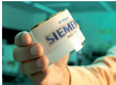
Prototyp eines schaltbaren und flexiblen Etiketts (Foto: Siemens)
