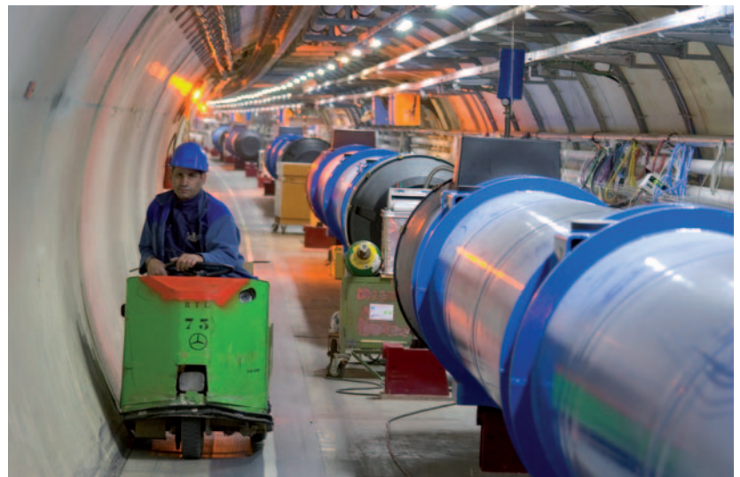
Abb. 1: Der Large Hadron Collider wird derzeit im 27 km langen Tunnel des ehemaligen Beschleunigers LEP beim CERN in Genf aufgebaut.
