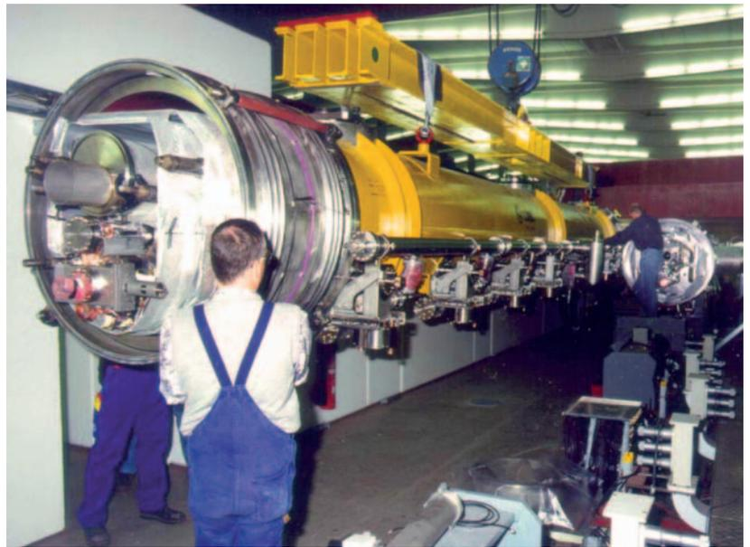
Der Linearbeschleuniger des Freie-Elektronen-Lasers bei DESY besteht u. a. aus rund 10 m langen Kryostaten (gelb), die acht supraleitende Resonatoren sowie einen supraleitenden Quadrupolmagnet enthalten.
