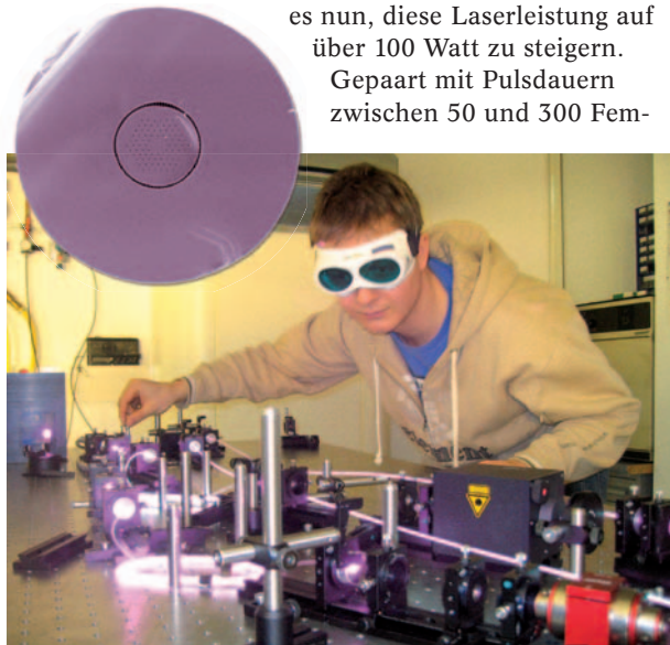
Photonische Kristallfasern, die in Längsrichtung mit luftgefüllten Kanälen durchzogen sind (oben), sind das Herzstück des neuen Ultrakurzpulslasers hoher Leistung. (Foto: FSU Jena)
