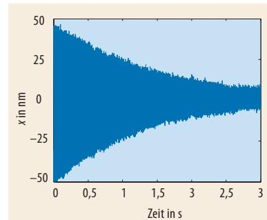
Mit dem Rastersondenmikroskop von S. Kuehn et al. [2] (Schema links) lässt sich die Abklingzeit der Kantilever-Schwingung bestimmen (oben) und damit auf die kontaktfreie Reibung infolge der dielektrischen Fluktuationen schließen.
