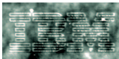
Mit Hilfe eines modifizierten Rasterkraftmikroskops „zeichneten“ Wissenschaftler dieses IBM-Logo aus DNA-Fragmenten. Die Linien sind zwischen 59 und 79 nm breit.
