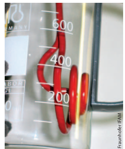
Ein Kunststoffgriff lässt sich dank des Füllstoffs MagSilica mit einem hochfrequenten Magnetfeld erwärmen und an ein Glas kleben.
