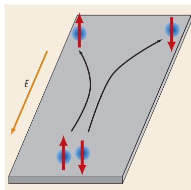
Beim extrinsischen Spin-Hall-Effekt werden Elektronen mit unterschiedlicher Spinpolarisation asymmetrisch gestreut. Das führt zu einem Spin-Ungleichgewicht senkrecht zur Elektronendrift und damit zu einer Spinpolarisation an den Probenrändern.
