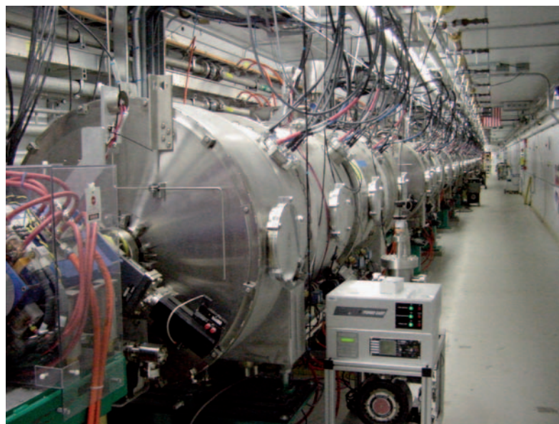
Abb. 4 Im Linearbeschleuniger werden die Protonen mithilfe von Hohlraumresonatoren aus supraleitendem Niob beschleunigt.
