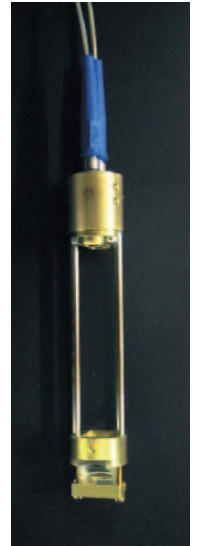
Abb. 6 Mit einem fasergekoppelten „open-path“-Sensor (rechts) lässt sich TATP im mittleren Infrarot nachweisen. Das beobachtete Absorptionssignal (oben) entspricht einer Konzentration von 100 ppm TATP in Raumluft.
