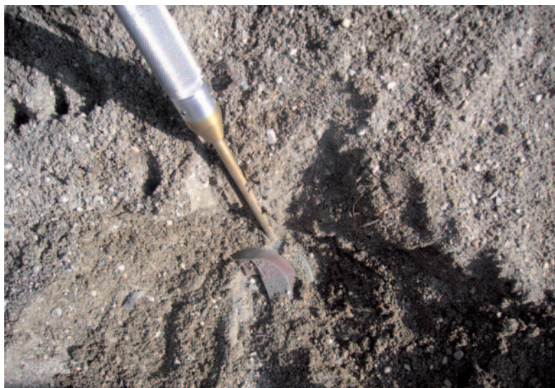
Eine Minensuchnadel mit integriertem laseroptischen Sensor erlaubt es im Feldversuch, Minengehäuse aus unterschiedlichen Metallen zu erkennen.
