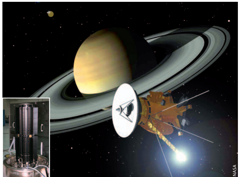
Abb. 1 Die Cassini-Sonde bezieht ihre Energie aus der Zerfallswärme von Plutonium, die thermoelektrische Konverter (Inset) in Strom umwandeln.
