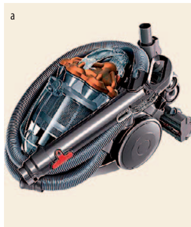
Abb. 2 Die beutellosen Dyson-Sauger trennen in mehreren Wirbelkammern mittels Zentrifugalkraft den Staub von der Luft (a). Dabei passiert die zunächst staubige Luft ein ausgefeiltes Zyklonsystem (b), das für reinste Luft sorgt.
