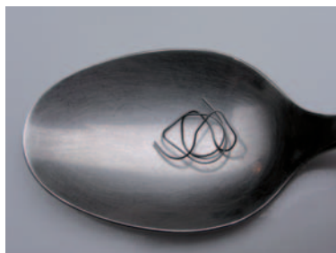
Wie man sie auch dreht oder wendet: Eine verbogene Büroklammer aus einer Nickel-Titan-Legierung „erinnert“ sich an
