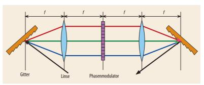
Gauß-Summen lassen sich durch Interferenz darstellen, indem man beispielsweise einen Femtosekundenpuls spektral zerlegt und die einzelnen Farben mit einer Linse der Brennweite f auf eine programmierbare Flüssigkristallzeile
