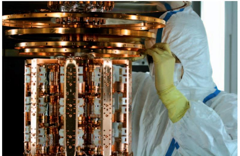
Ein Blick auf das Herzstück des CRESST-Experiments. Zu sehen ist das „Karussell“, in dem die Detektor-Module montiert sind.
