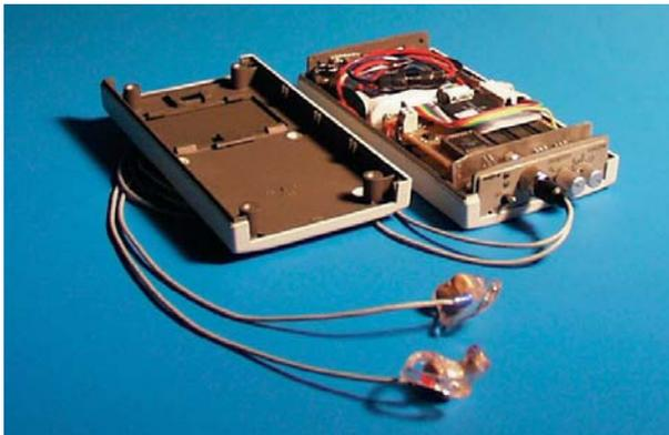
**Abb. 7:** Digitales, binaurales Prototyp-Hörgerät, das im Rahmen eines BMBF-Verbundprojekts zusammen mit der FH Nürnberg und der Universität Gießen entwickelt wurde.
