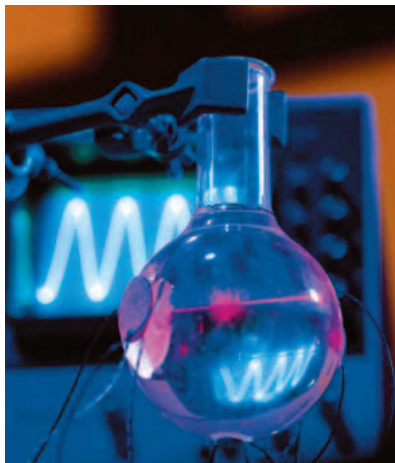
Sonoluminiscenz-Apparatur an der Universität Twente. An den Seiten des Glaskolbens erkennt man die Ankopplungselemente für das Ultraschallfeld, in der Mitte des Kolbens das Leuchten der Gasblasen. (Foto: D. Lohse)
