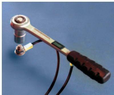
**Innovative Werkzeuge wissen, worauf es ankommt: Mithilfe einer dünnen drucksensitiven Schicht, die auf einer Unterlegscheibe aufgebracht ist, lässt sich der Anpressdruck einer Schraubenverbindung durch eine einfache Widerstandsmessung exakt bestimmen. (Quelle: Fraunhofer IST)**
