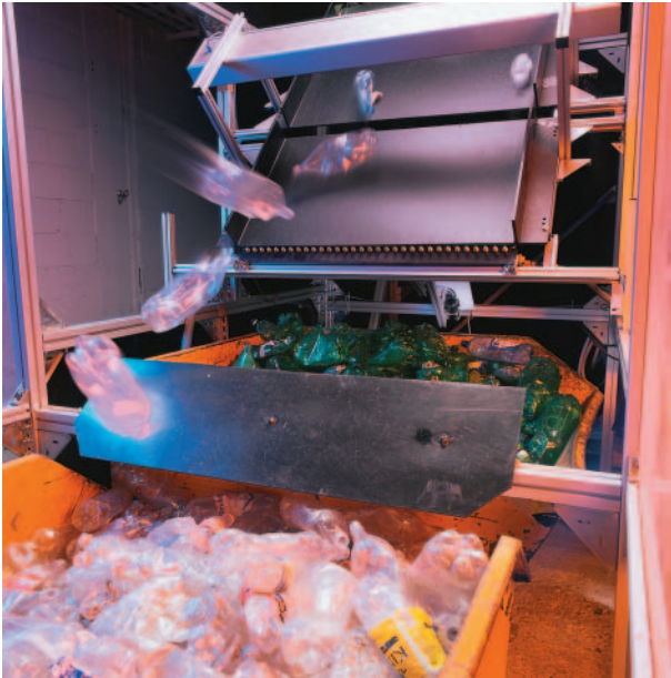
Abb. 1: Mit Nahinfrarot-Technologie lassen sich gebrauchte Verpackungen je nach Kunststoffart trennen. Weitere Trennschritte sind möglich, etwa, wie hier im Bild zu sehen, PET-Flaschen nach Farben sortieren. (Foto: DKR)
